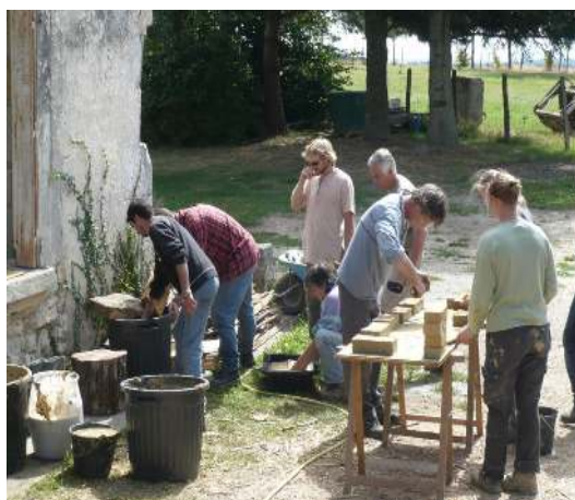
Atelier de fabrication brique en terre crue
